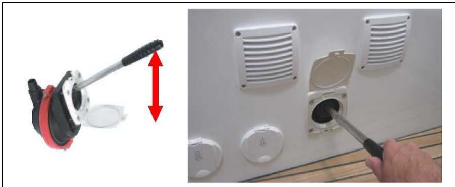
I- Bedienhebel in die Handlenzpumpe stecken.
