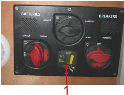
1. Schutzschalter - Solarpaneele
