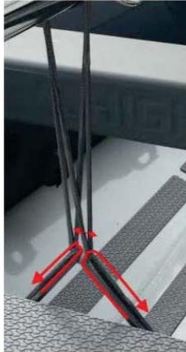
3. Die 2 Schlingen mit den Niro-Schäkeln an am Beiboot befestigen.
