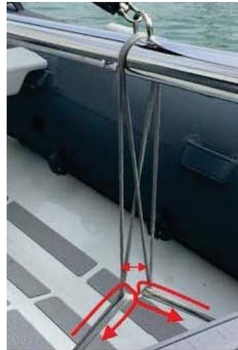
3. Die 2 Schlingen mit den Niro-Schäkeln an am Beiboot befestigen.
